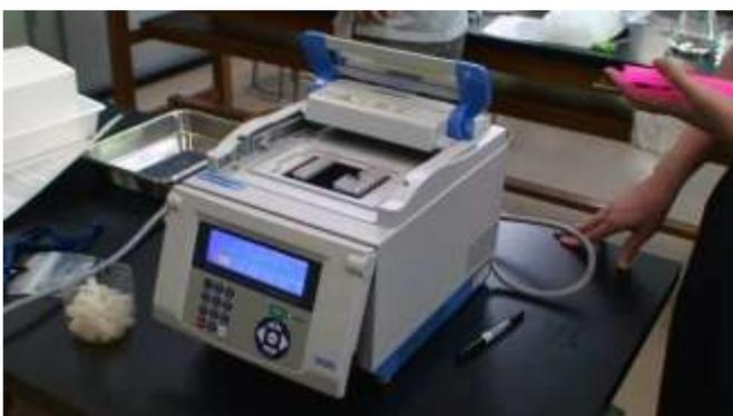
写真 2: サーマルサイクラーと呼ばれる装置です。DNA の調べたい部分のコピーを大量に作る PCR(ポリメラーゼ連鎖反応)を自動的に行うことができます。
