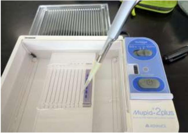
写真 3: 電気泳動装置(ミュピッド)と呼ばれる水平に入れた寒天の板(ゲル)に電圧をかける装置です。ゲルの端のくぼみ(ウェル)に DNA を入れているところです(DNA サンプルには青い色素を混ぜて見やすくしてあります)。DNA は-に帯電しているので電圧をかけるとゲルの中を+極に向かって移動します。この写真では右から左です。
